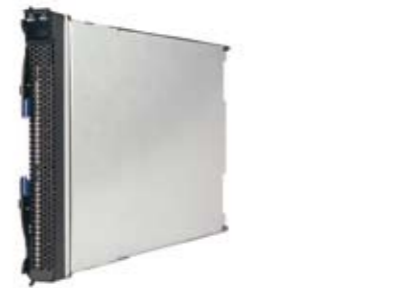
A BladeCenter keretben 14 darab, kétutas HS21 penge fér el
